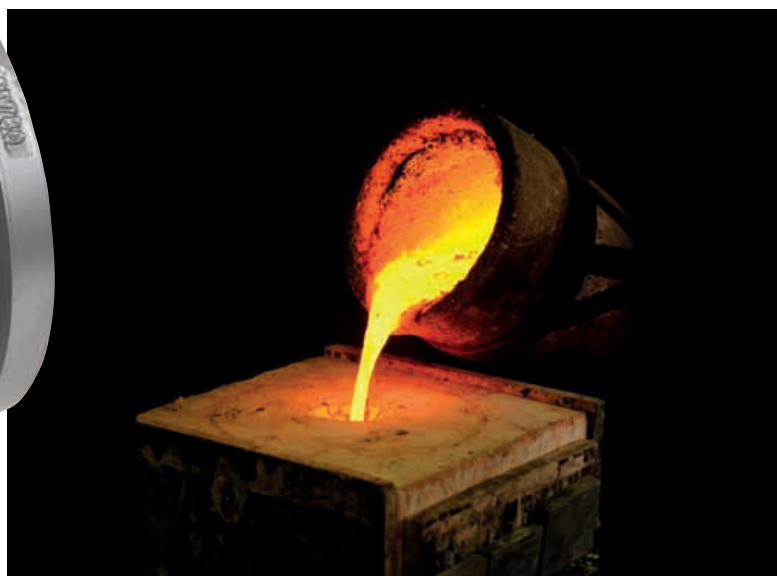
Abguss mit Stahlschmelze
