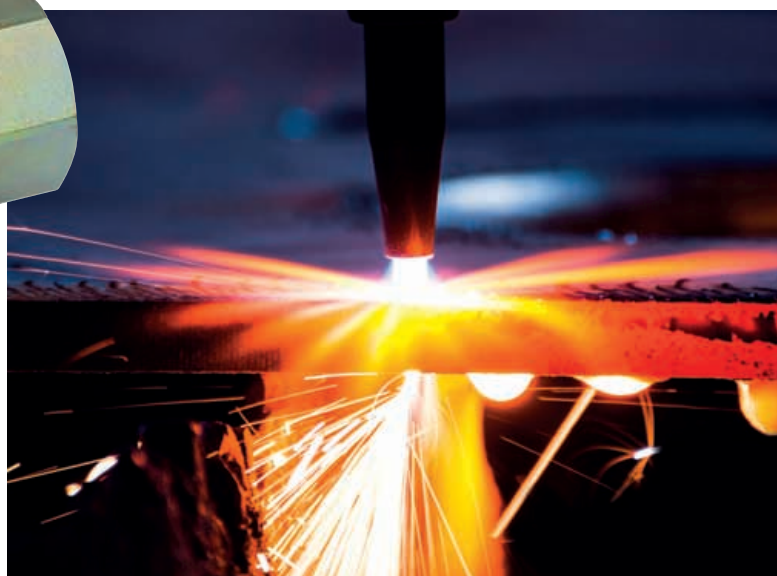
Autogenschneiden eines 50 mm-Blech
